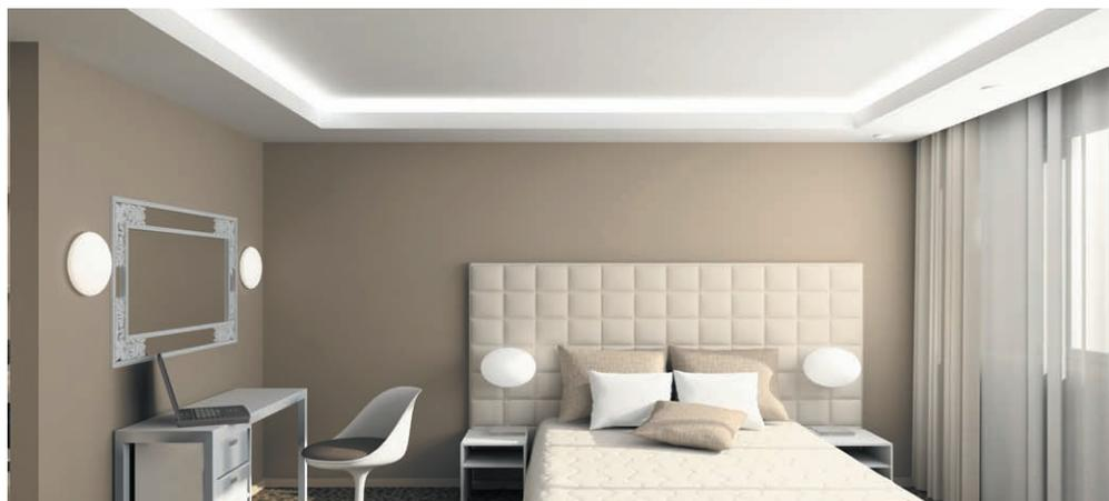
**Рис. 8.58.** Трубчатые люминесцентные лампы, располагаясь за карнизом из гипсокартона, создают мягкое и равномерное освещение по периметру комнаты
