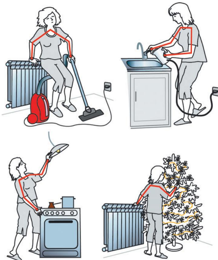
Рис. 3.8. Возможные причины поражения электрическим током
