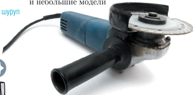
**Рис. 2.43.** Углошлифовальная машина с защитным кожухом (болгарка)
