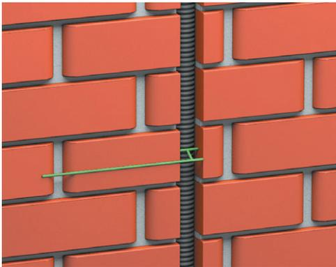
**Рис. 6.27.** Скрытая укладка кабеля в гофрированной трубе: глубина штробы должна быть такой, чтобы от гофры до края выемки было не менее 5 мм
