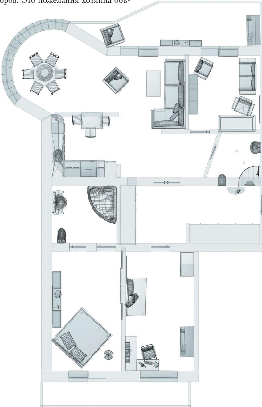
**Рис. 6.9.** Перед тем как расставлять электрические точки на схеме, необходимо начертить подробный план будущей обстановки
