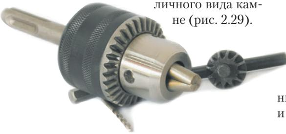
**Рис. 2.28.** Сменная головка перфоратора с кулачковыми зажимами
