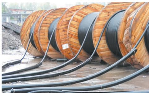
Рис. 4.3. Барабаны с силовым кабелем
