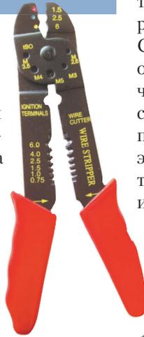
Рис. 2.23. Клещи для обжима кабельных гильз
