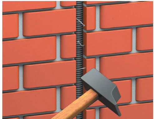
**Рис. 6.28.** Трубу крепят в штробе при помощи обычных гвоздей или прижимают, закручивая шурупы (если позволяет материал стены)
