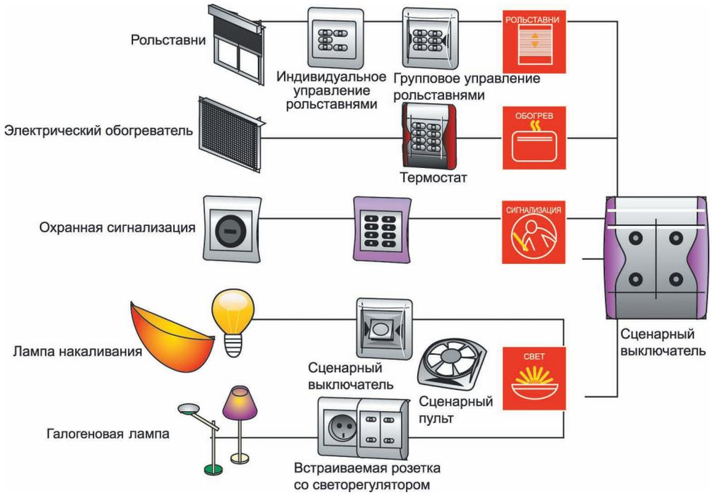
Рис. 12.5. Пример минимальной комплектации системы
