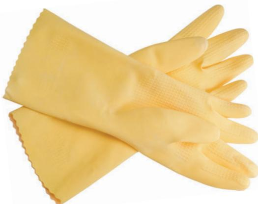
**Рис. 3.16.** Диэлектрические перчатки для работы с напряжением до 1000 В. Такие перчатки бывают двух видов: первый — для работы под напряжением до 1000 В, второй — свыше этого значения. В домашней работе с электричеством перчатки второго вида практически не используются. Они более толстые и менее эластичные
