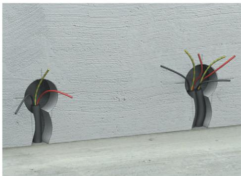
**Рис. 6.42.** Шаг четвертый: заливается цементный раствор и стяжка выравнивается
