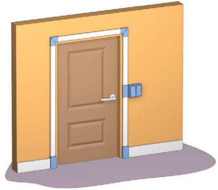
**Рис. 6.79.** На рисунке использован плинтус под электропроводку
