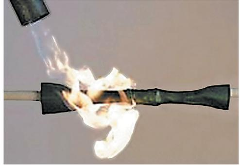
**Рис. 4.78.** Термоусадочная трубка, обрабатываемая пламенем горелки
