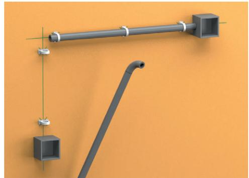
**Рис. 6.73.** Шаг пятый: разрежьте трубы на куски необходимой длины, а потом укрепите их в клипсах, подгоняя размеры аксессуаров
