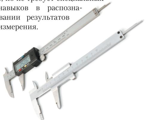
**Рис. 2.18.** Механический и цифровой штангенциркули
