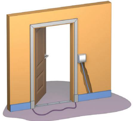
**Рис. 6.81.** Кабель должен быть вмонтирован в пол на достаточную глубину
