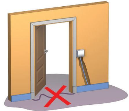
**Рис. 6.80.** Кабель не должен пролегать слишком близко к поверхности пола
