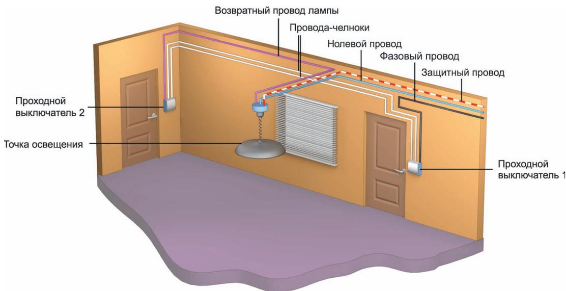
**Рис. 8.24.** Пример использования проходных выключателей (переключателей)
