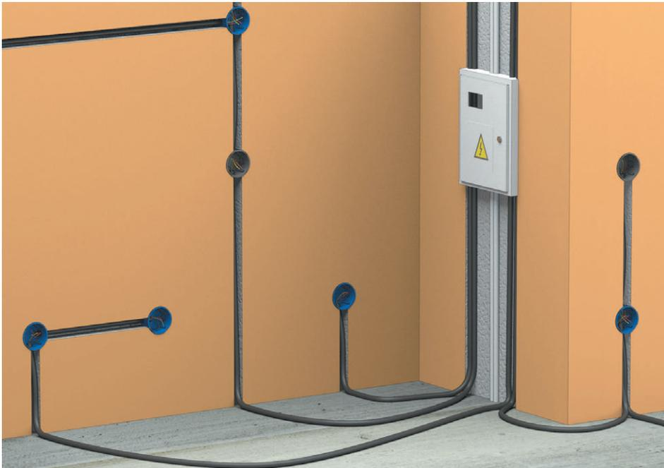
**Рис. 6.37.** Трубы, расположенные внизу, позднее будут под полом
