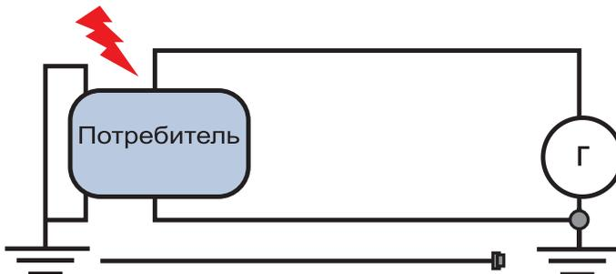
Рис. 1.6. Простейшая схема заземления
