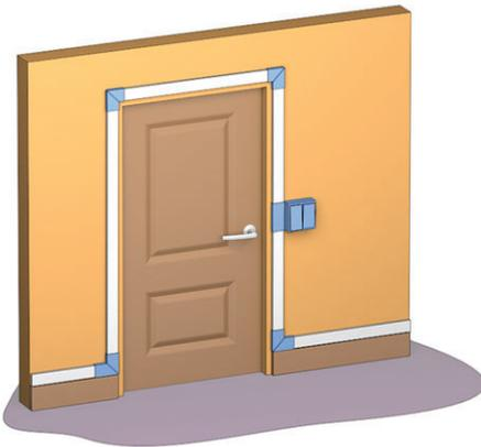
**Рис. 6.78.** Пример прокладки кабеля вокруг дверной коробки
