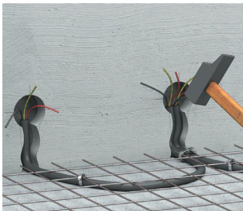
**Рис. 6.41.** Шаг третий: после того как трубы укладываются на полу, они накрываются армирующей сеткой и прикрепляются к этому слою хомутами
